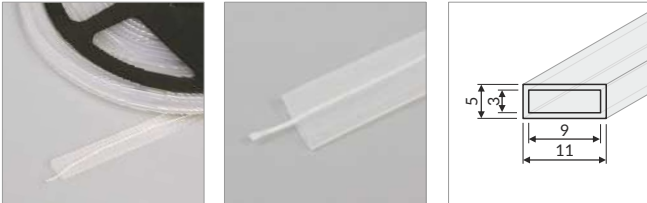
Silikonhülle für LED Streifen mit 8 mm silicone housing for 8 mm LED strip
